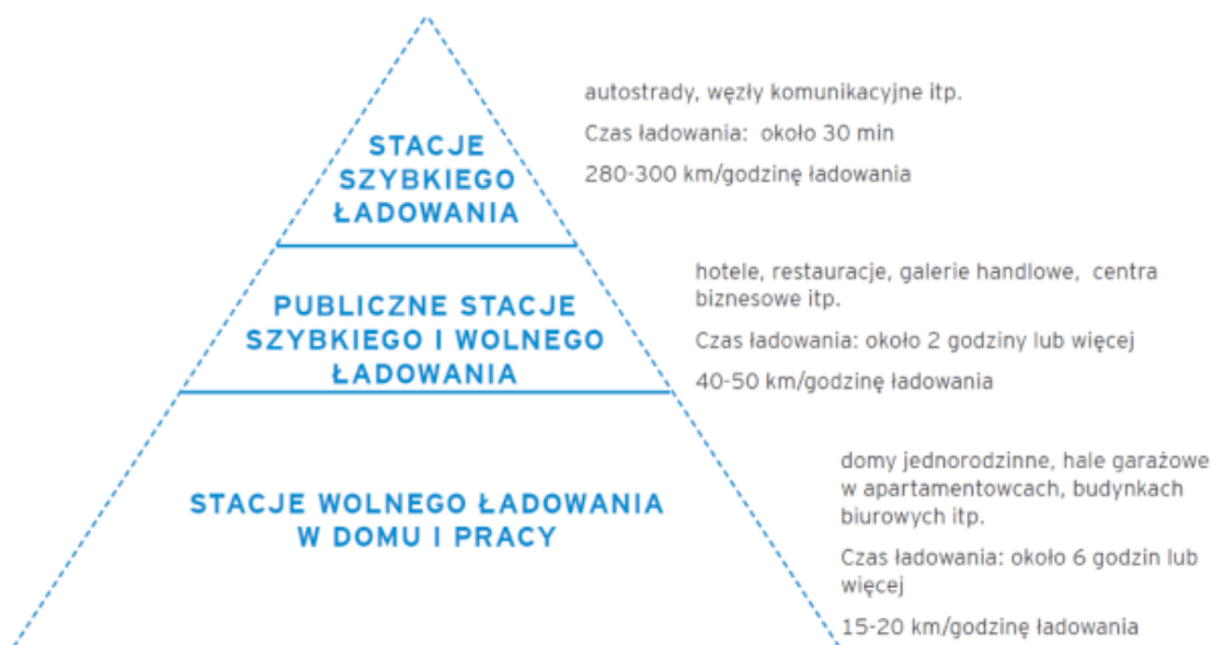
Rysunek 10. Rekomendowany miks infrastruktury ładowania pojazdów EV Źródło: Infrastruktura ładowania Pojazdów Elektrycznych, Wytyczne dla miast, GreenWay, CleanTechnica Warszawa 2018, s. 15
